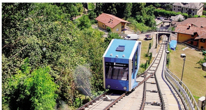
Una delle due carrozze della funicolare VALBREMBA NAWE
